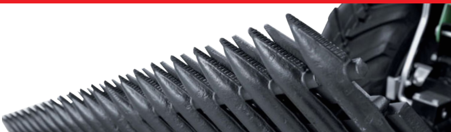
Sistema di taglio Mulching Controcottello in acciaio fuso per garantire nel tempo affidabilità e un'eccellente qualità del taglio Mulching cutting system Cast steel blade contrast to guarantee long-lasting reliability and excellent cutting results
